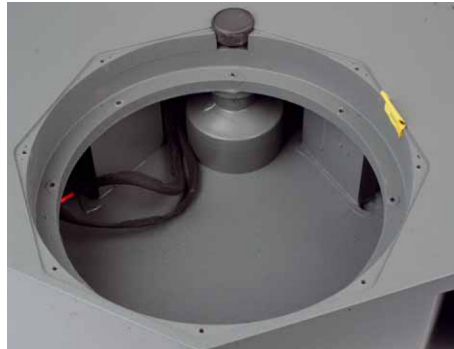
Jede Menge Versteifungsbrettchen und eine aufgeweitete Dornaussparung beim RES 10 AR
